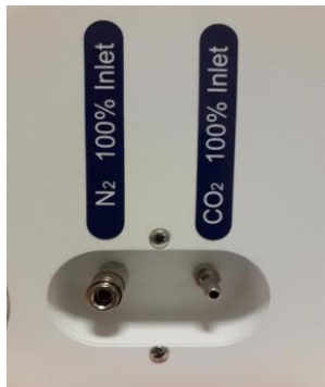
Фигура 11.1 Входни отвори за газ на гърба на MIRI® и MIRI® Humidity многокамерни IVF инкубатори
